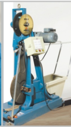
Charpy Impact Testing Machine 沖擊試驗機
